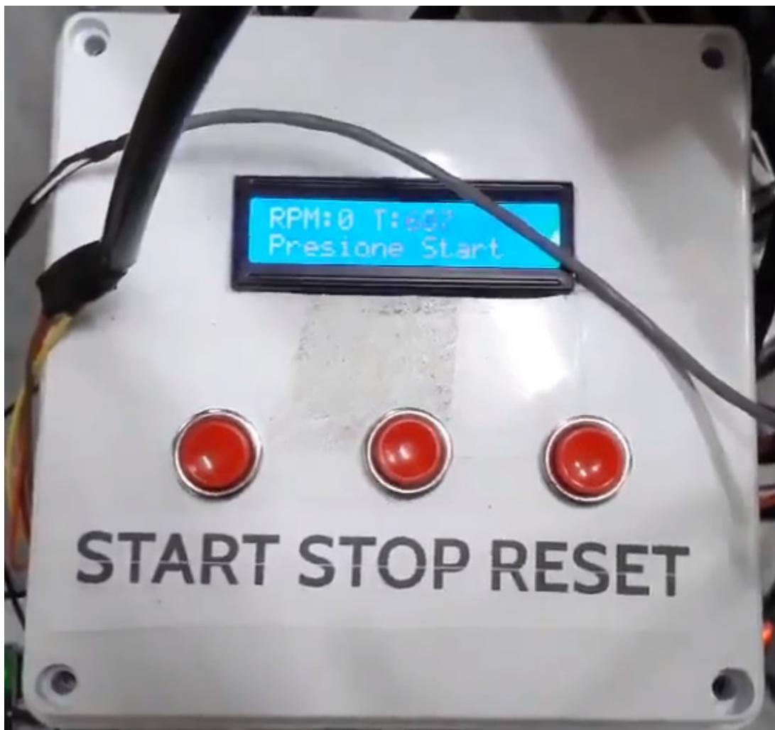
Fig. 8.1: Contenedor del controlador implementado
