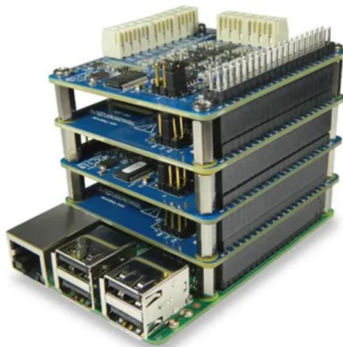
Figura 16 APILAMIENTO DE DAQ HATs en Raspberry PI
