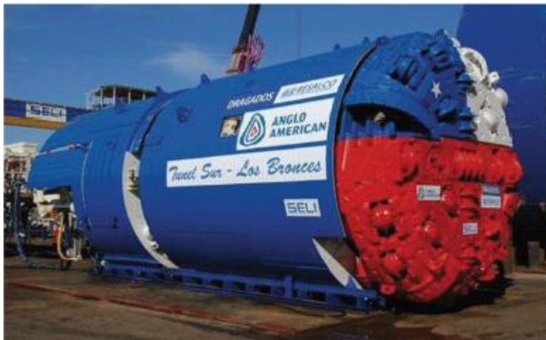
Ilustración 2.3 TBM para túnel de exploración de Los Bronces (Brox, 2013).
