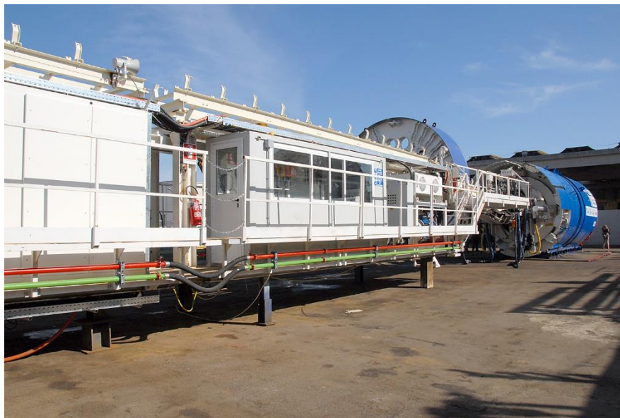
Ilustración 2.4. Back-up TBM (Besalco, 2021).
