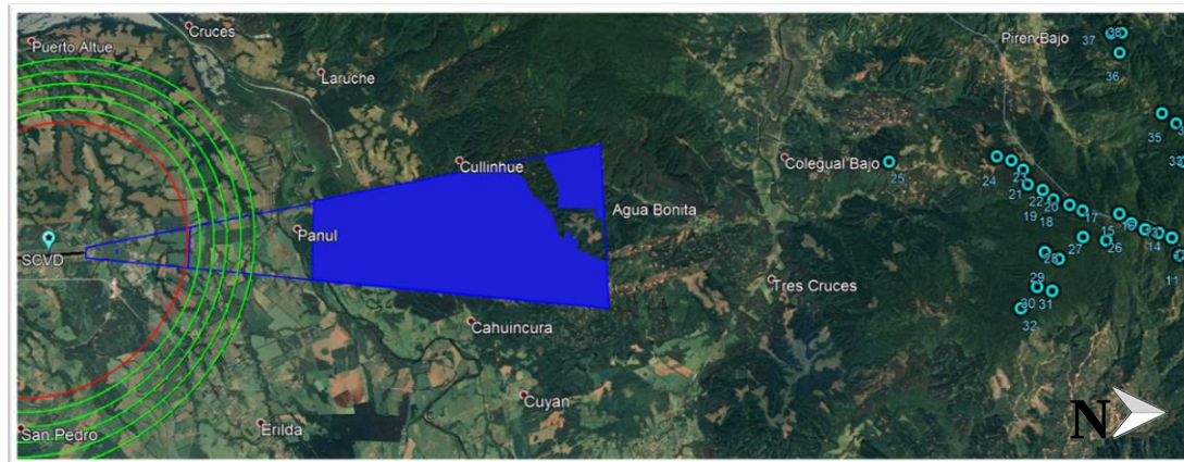
Figura 3-22: Superficies limitadoras aeródromo SCVD y parque eólico.
