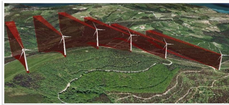
Figura 3-8: Sombra provocada por el aerogenerador.
