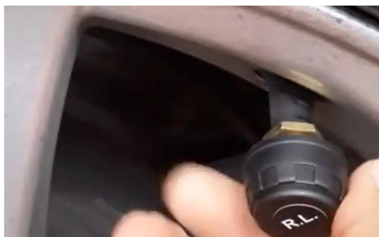
Figura 6.3 Instalación de sensor.
