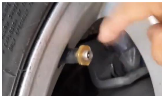
Figura 6.2 Instalación de contratuerca.
