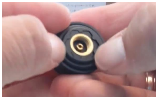
Figura 5.7 Instalación de sellos
