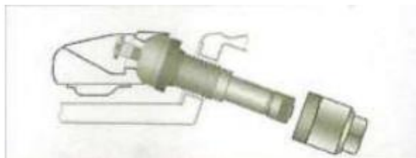
Figura 2.4 Ensamble sensor en la llanta
