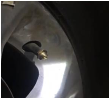
Figura 3.0 Instalación de contratuerca.
