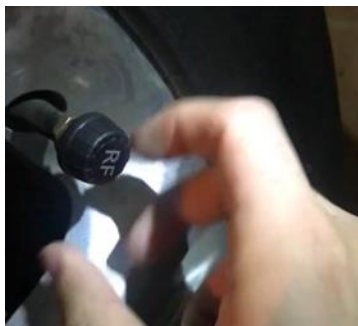
Figura 3.1 Instalación de sensor en la válvula.
