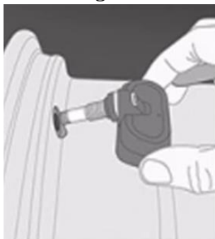
Figura 2.0 Instalación de sensor en el orificio de la llanta.
