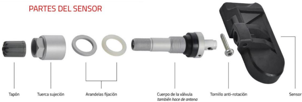
Figura 1.5 TPMS de válvula de encaje (Despiece)
