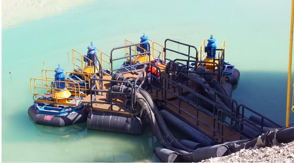
Figura 2.12: Bombas VS5 en operación (1). [9]
