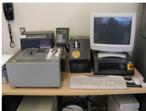
Figura 2- 9: Equipo de ensayo de tracción directa (DTT)
