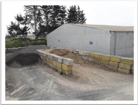
Imagen B-17 Acopios áridos; Gravilla 13 [mm] (lado izquierdo), Arena fina (lado derecho).
