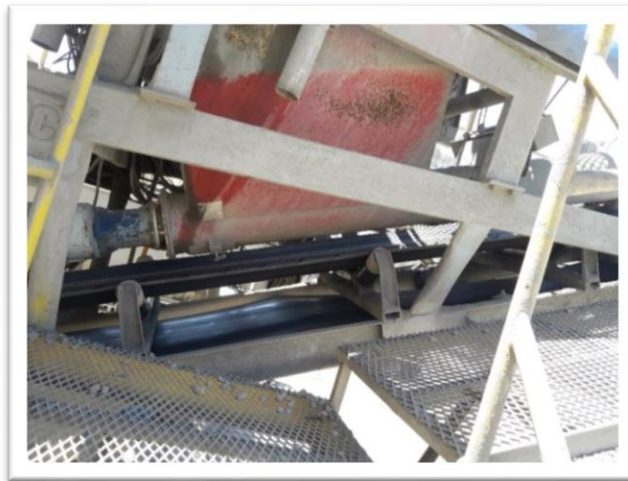
Imagen 3-4; Tornillo sinfín desde báscula de cemento
