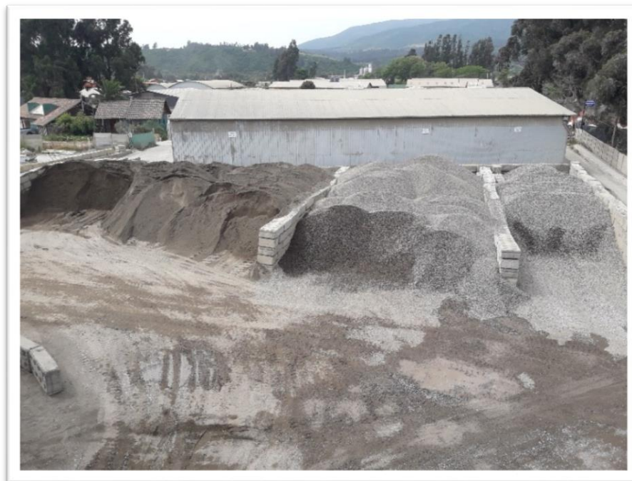
Imagen B-16; Acopios áridos; Grava (lado derecho), Gravilla 20 [mm] (sector medio), Arena Industrial (lado izquierdo).
