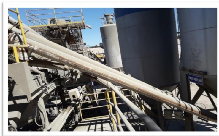
Imagen 3-3; Tornillo sinfín unido de silo a báscula de cemento
