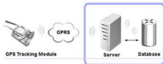
Figura 2.2: Transmisión de ubicación al servidor [3]
