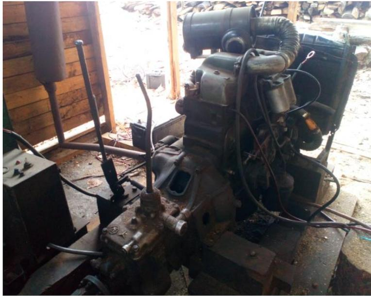
Figura 10: Motor estacionario mercedes-benz OM314
