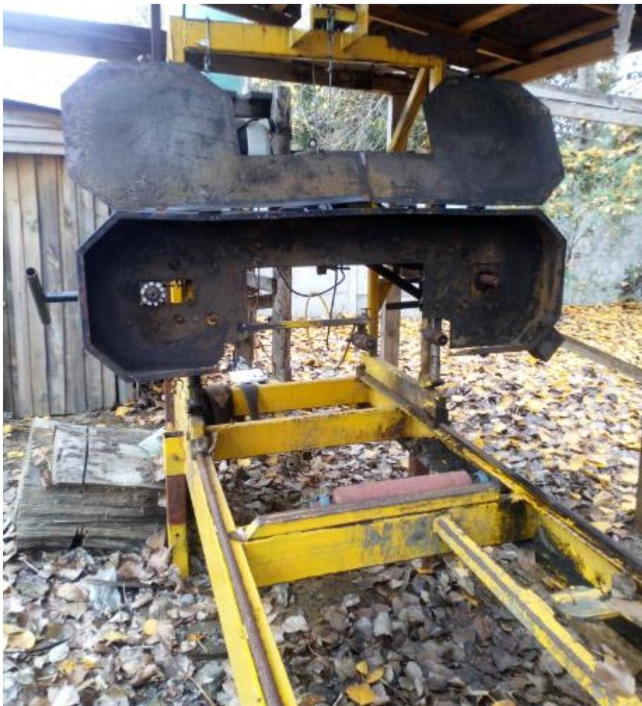
Figura 5: Vista frontal de aserradero de banda horizontal.
