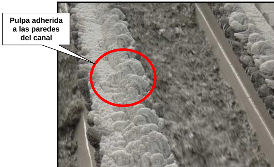
Figura 3-8: Fotografía que refleja el efecto de salpicaduras (corales de relave)
