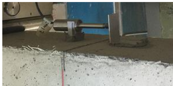
Figura 5.5.: Probeta entallada con abrazadera que recibe al transductor y escuadra metálica.
