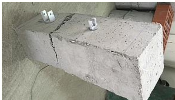
Figura 5.8.: Probeta con las marcas de los tercios, abrazadera y escuadras.
