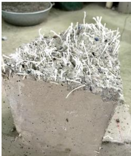
Figura 2.1.: Distribución de fibras en probeta de hormigón.
