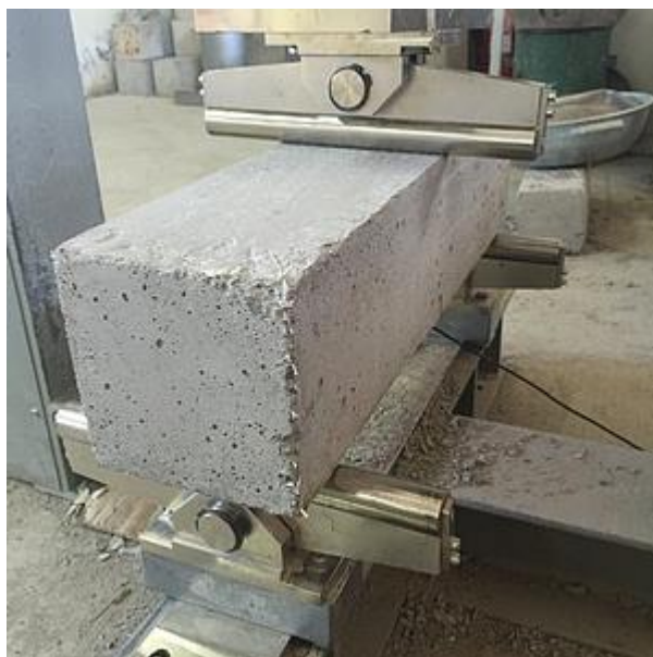
Figura 5.6.: Probeta instalada según esquema general EN-14651.
