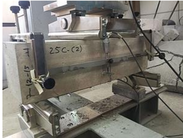
Figura 5.9.: Abrazaderas y estructura del transductor que mide la flecha.
