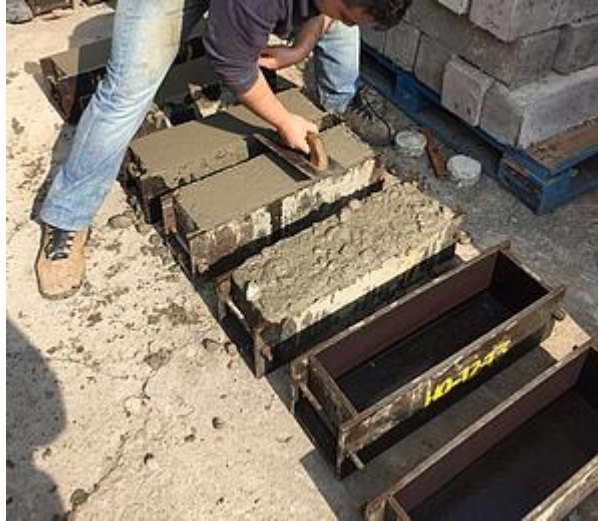
Figura 5.3.: Probetas de hormigón durante el proceso de llenado, vibrado y enrasado.
