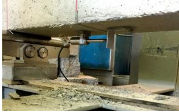
Figura 3.1.: Transductor de deformación instalado en la parte inferior de la probeta.
