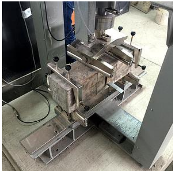
Figura 3.2.: Probeta de ensaye con cargas en los dos tercios de la luz.
