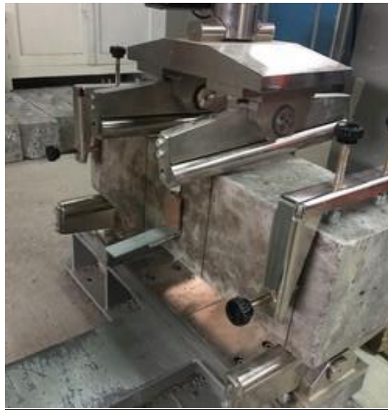
Figura 2.8.: Probeta prismática según ensayo ASTM C-1609.
