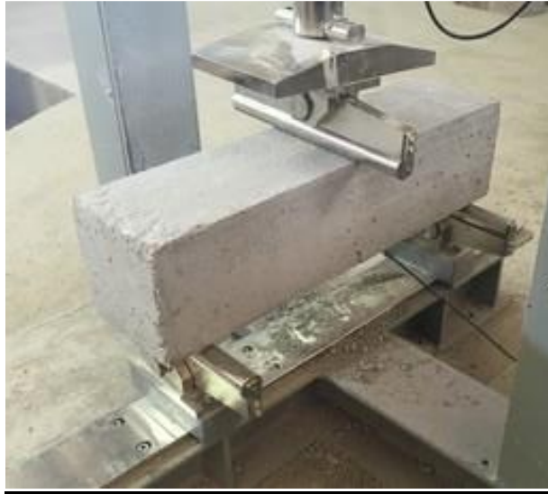
Figura 2.9.: Probeta prismática según ensayo EN-14651.
