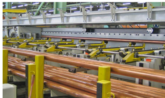
Figura 2-5: Recibidor lateral banco Bültmann. (Fuente: Bültmann GmbH, 2023)
