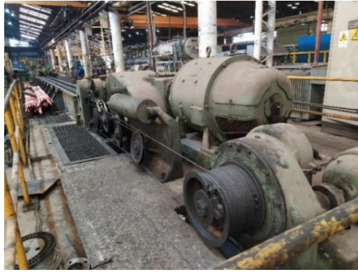
Figura 1-19: Banco de trefilado, visto desde el motor eléctrico.
