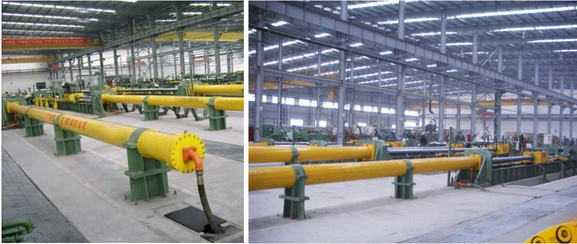
Figura 2-3: Bancos de trefilado. (Fuente: Suzhou Senbo Machinery Co., Ltd, 2018)
