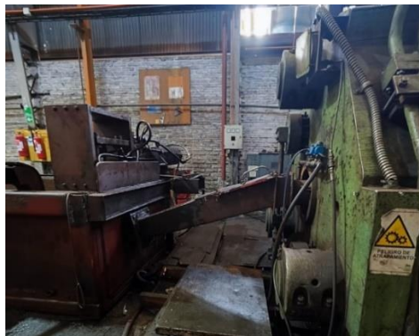
Figura 1-7: Segmento de transición entre prensa y wax-tank
