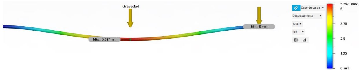
Figura 2-8: Deflexión simulada, ajustado 0.5x
