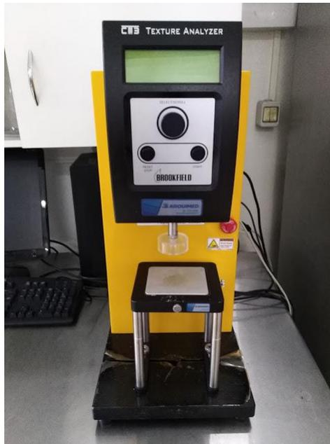
*Figura 18 Texturómetro Brookfield CT3*
