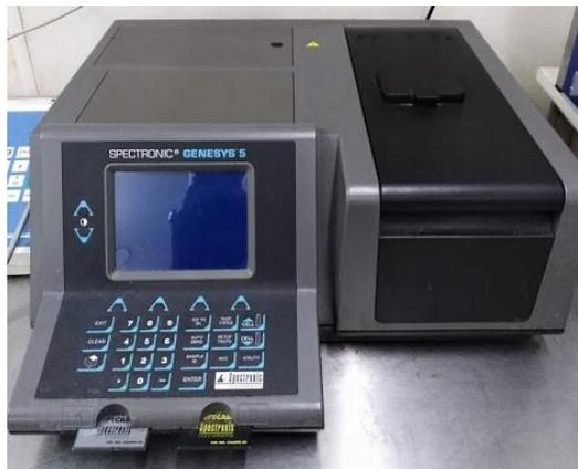
Figura 19 Espectrómetro Spectronic, GENESYS 5
