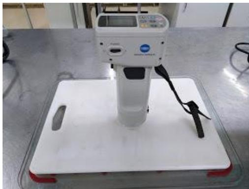
Figura 17 Colorímetro Konica Minolta CR-400
