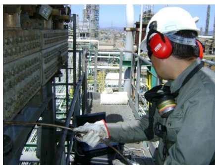
FIGURA 2.3: EDDY CURRENT A HACES TUBULARES
