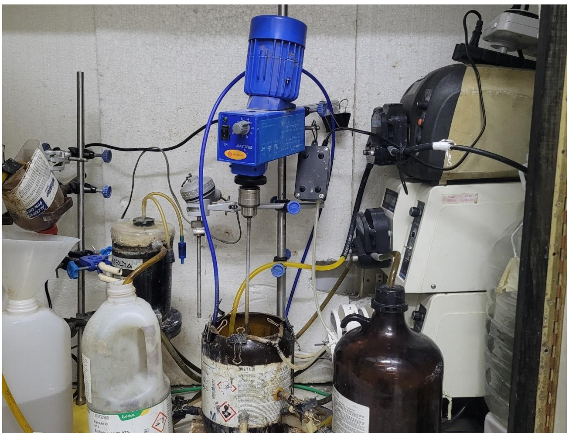
Figura 2-2 : Configuración trabajo experimental reactor CSTR-UAF
