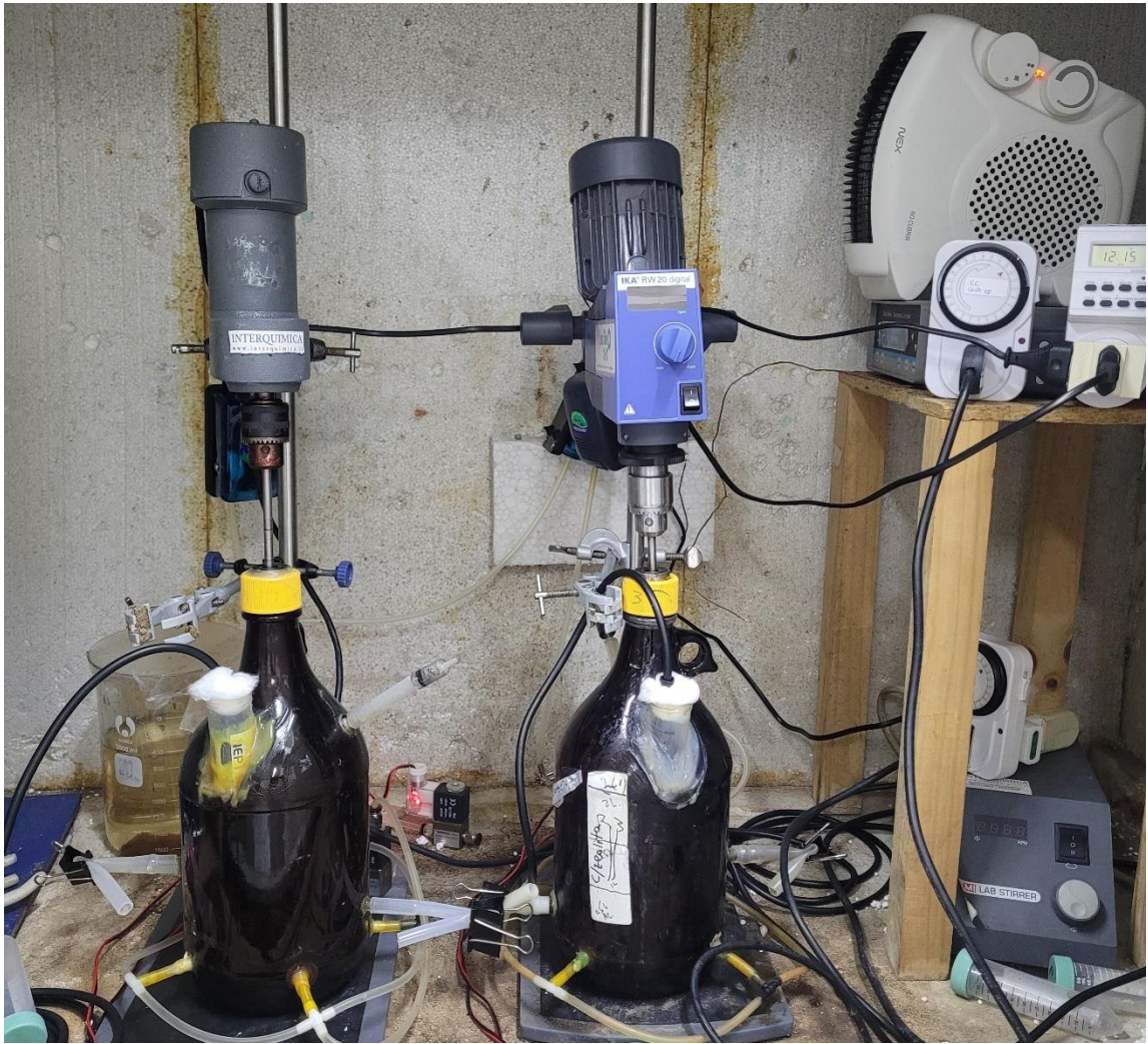
Figura 2-1: Configuración trabajo experimental reactor SBR
