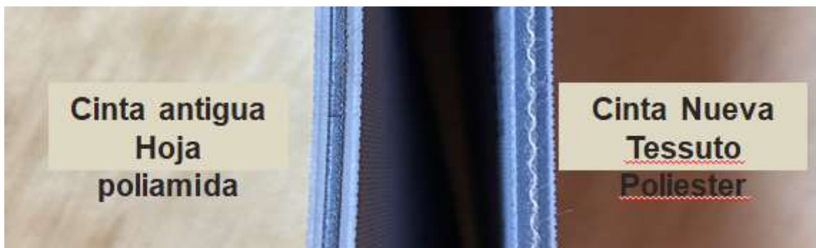
Imagen N° 19: diferencias de tejidos internos de cinta transportadora.
