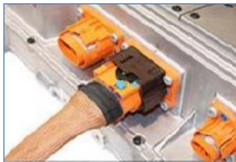
Ilustración 4-1. Cableado de corriente máx. 230 [A].
