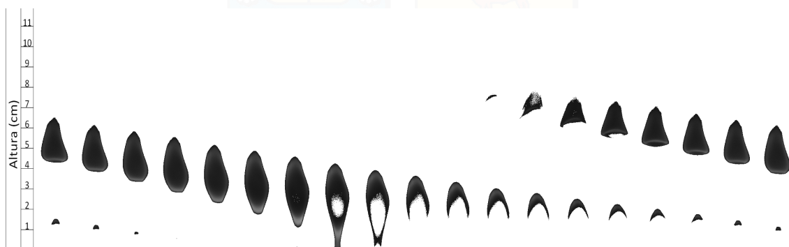
Figura A.5: Secuencia de imágenes de llama: Q_{etileno} = 135 sscm, 15 hertz, 52 % de potencia
