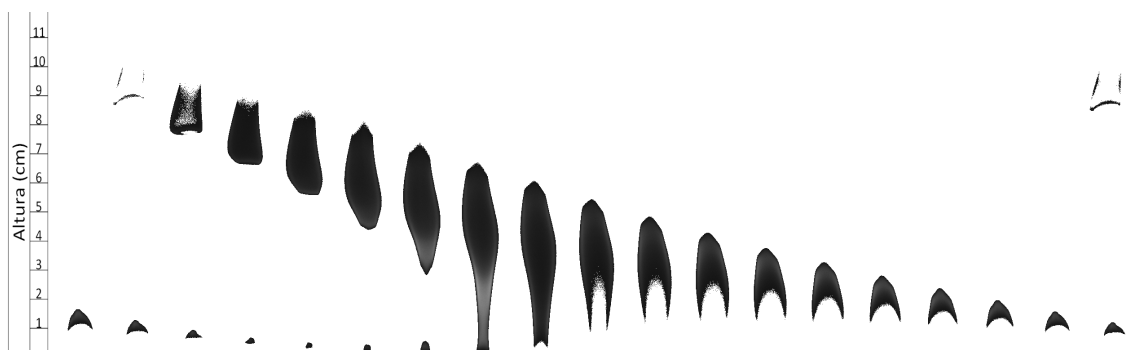
Figura A.3: Secuencia de imágenes de llama: Q_{\text{etileno}} = 135 sscm, 10 hertz, 40 % de potencia
