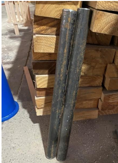
Figura 4: Barras de acero del molino de barras.
