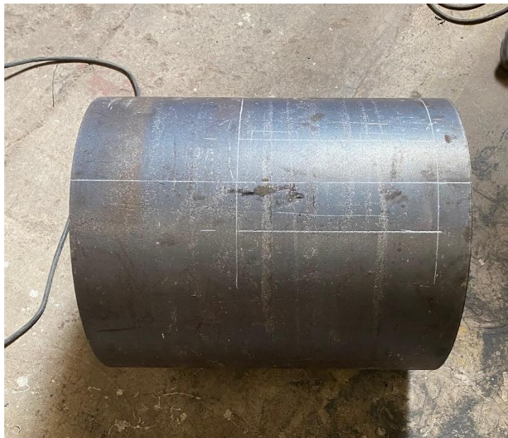
Figura 26: Proceso construcción 1 molino de barras.
