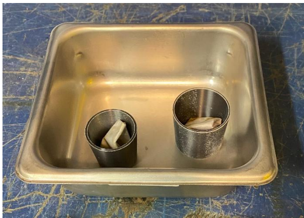
Figura 21: Filtros en crisoles, antes de la calcinación.
