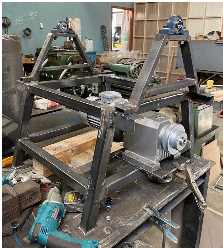
Figura 28: Proceso construcción 3 molino de barras.
