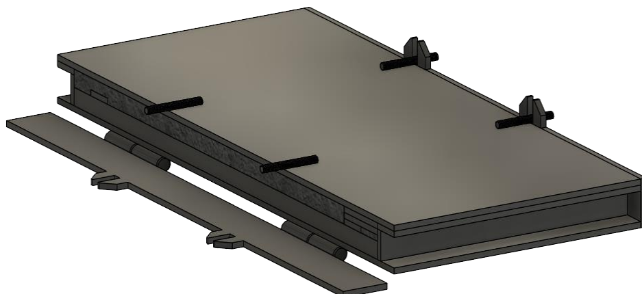
Figura 2-12. Apertura del molde después del enfriamiento.
