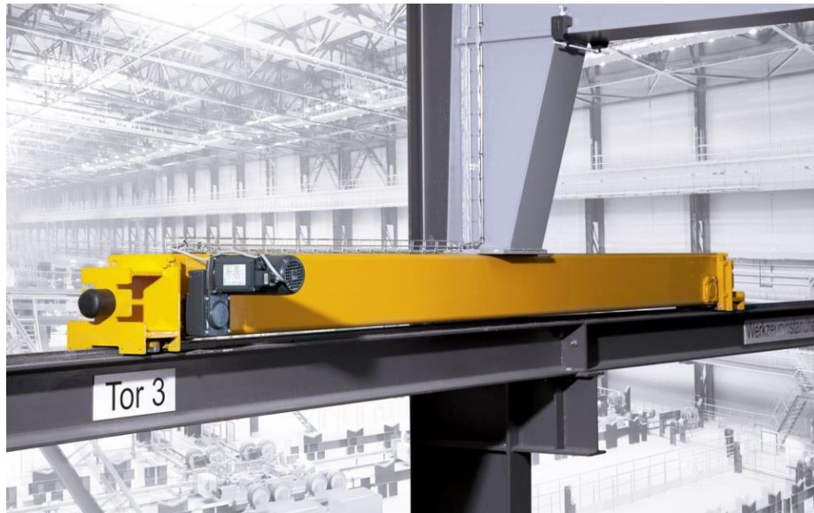
Figura 1.9 Par de vigas testeras con sus respectivos mecanismos de traslación.
