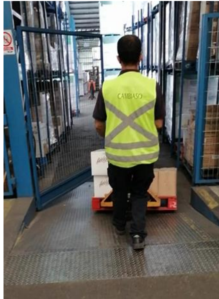
Fotografía 4-3 Presencia de ramplas en el empuje de carga
