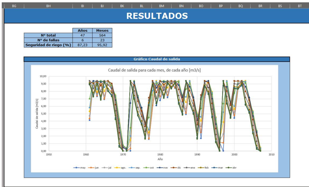
Figura 10: Gráfico de caudales de salida obtenidos al aplicar el código de modelación de embalses
