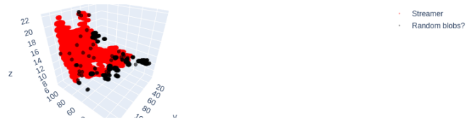
Figure 7.24: Diagrama 3D de los vóxeles eliminados y sobrevivientes al proceso de limpieza de clustering. En color rojo los vóxeles de la nube sobreviviente. En color negro los vóxeles eliminados.
