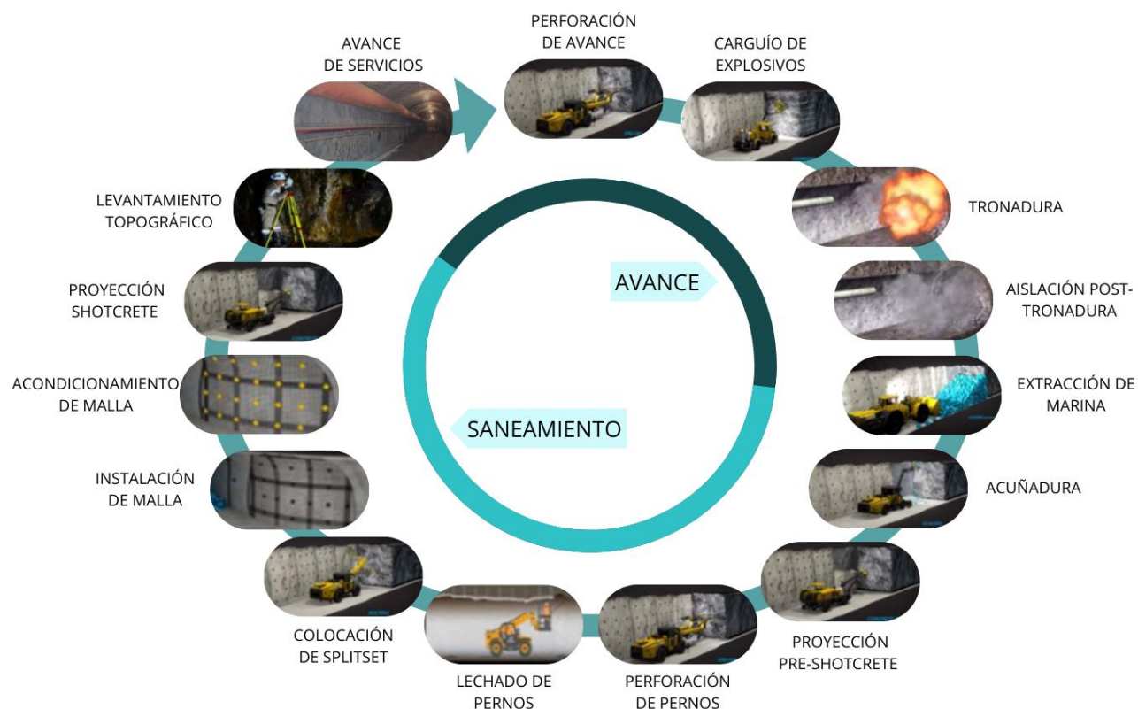
Ilustración 4: Esquema del Ciclo Minero (Cortez, 2020)
