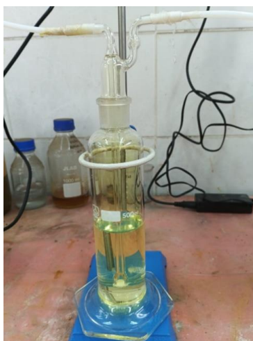
Figura 24: Limpiador de gases.
