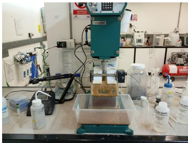
Figura 22: Sistema de flotación.
