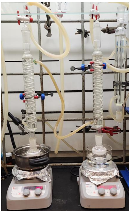
Figura 4.1: Montaje experimental proceso de funcionalización de superficies de silicio.
