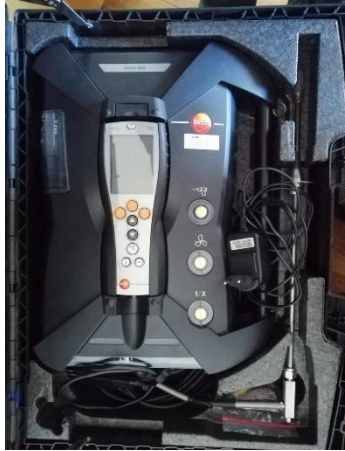
Figura 4.19: Analizador de gases Testo 350. Fuente: Elaboración propia.
