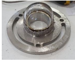
Figura 4.23: Instalación de cúpula en pieza de asiento. Fuente: Elaboración de Paula Rojas.
