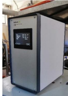
Figura 4.11: Generador de Vapor E – 1500 Cellkraft. Fuente: Elaboración propia.
