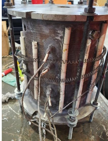
Figura 4.28: Montaje de resistencia eléctrica. Fuente: Elaboración propia.
