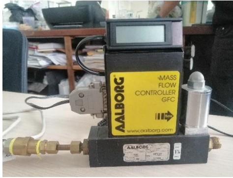
Figura 4.15: Controlador de flujo utilizado Marca Aalborg modelo GFC – 37.
