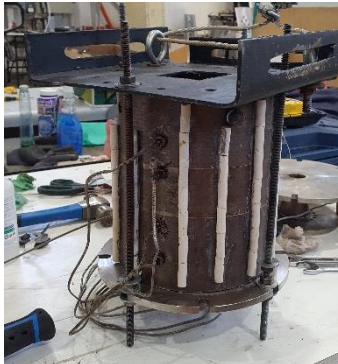
Figura 4.25: Montaje de espárragos al reactor. Fuente: Elaboración propia.
