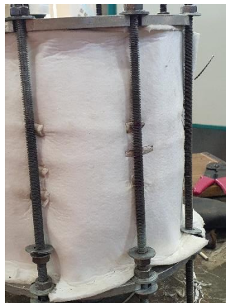
Figura 4.29: Aislante en reactor. Fuente: Elaboración propia.
