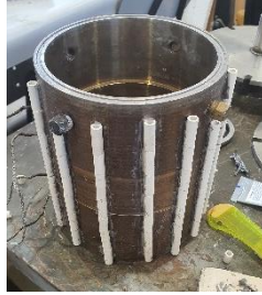
Figura 4.22: Sistema de varillas cerámicas en el reactor. Fuente: Elaboración Paula Rojas.
