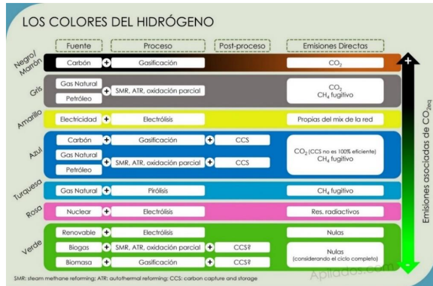
Figura 3.4: Esquema conceptual de los colores del hidrógeno con las distintas fuentes, procesos, post-procesos y emisiones. Fuente: Agencia Internacional de la Energía.
