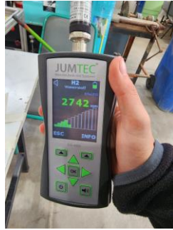
Figura 5.3: Medición con detector de hidrógeno. Fuente: Elaboración propia.
