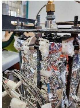
Figura 4.30: Ajuste de tuercas a pletina soporte del reactor. Fuente: Elaboración propia.
