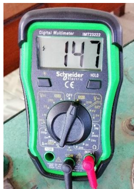
Figura 4.17: Multímetro digital Cat.3 SCHNEIDER ELECTRIC IMT 23222 Thorsman. Fuente: Elaboración propia.
