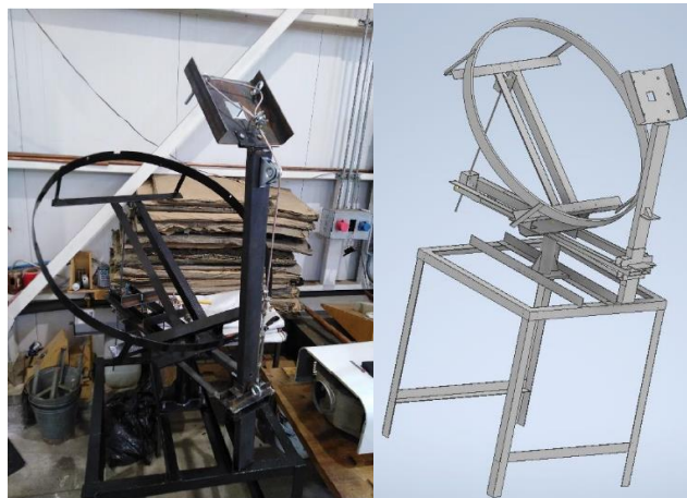
Figura 4.8: Primera imagen: Estructura real del brazo soporte realizado por Sebastián García. Segunda Imagen: Modelo Autodesk Inventor de la estructura soporte del reactor. Fuente: Memoria Sebastián García.
