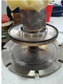
Figura 4.24: Ajuste de pieza de asiento en reactor. Fuente: Elaboración de Paula Rojas.
