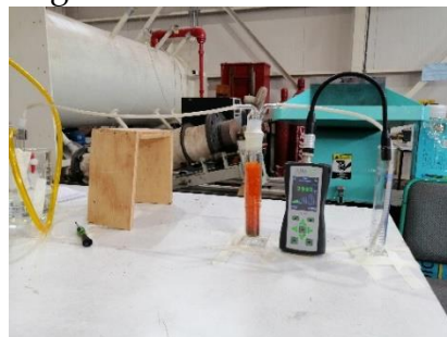
Figura 4.18: Arreglo de medición para detectar hidrógeno con equipo Jumtec GS-400. Fuente: Elaboración propia.
