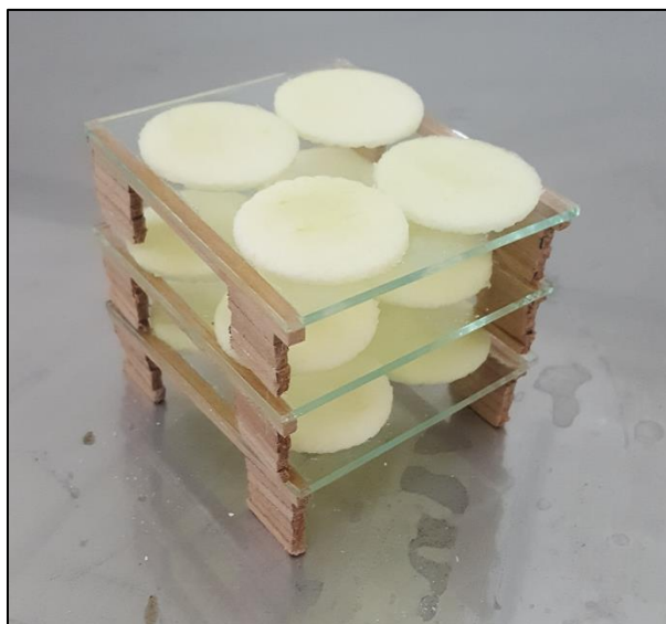
Figura 16 Sistema de bandejas para secado de manzanas en túnel de aire.
