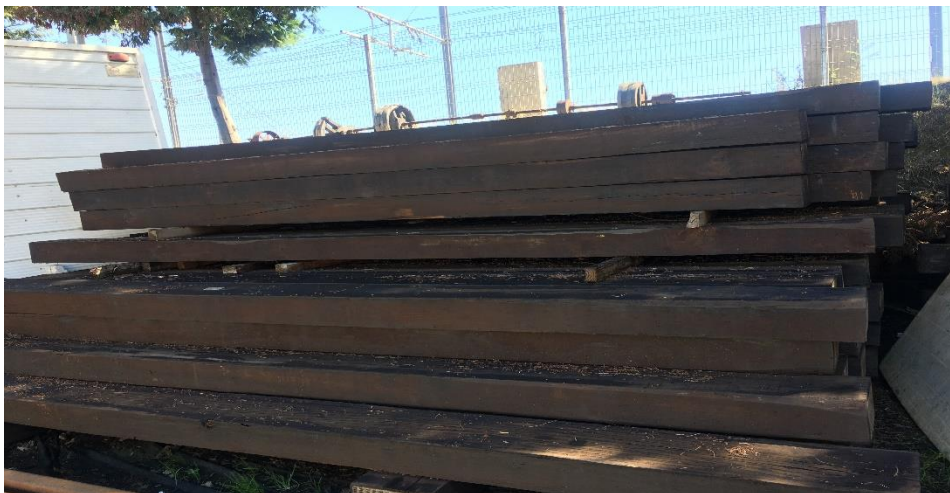
Figura N°1- 4 Durmientes de Desviador
