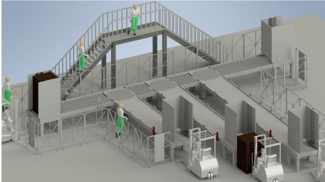
Fuente: Elaboración propia en Inventor Profesional. Ilustración 2-2. Modelado preliminar.
