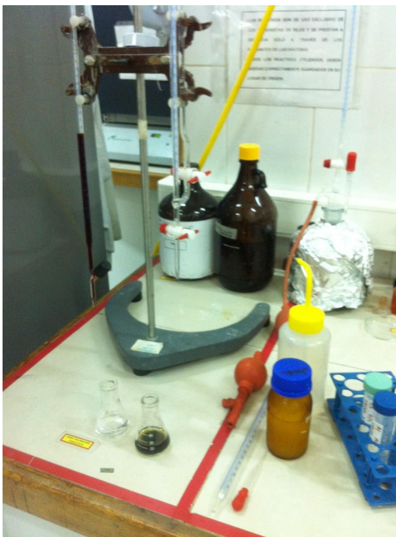
Figura 42. Estación de medición de tiosulfato con sus materiales y reactivos necesarios
