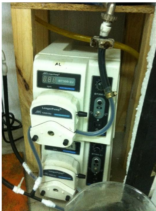
Figura 24. Sistema de bombas del equipo
