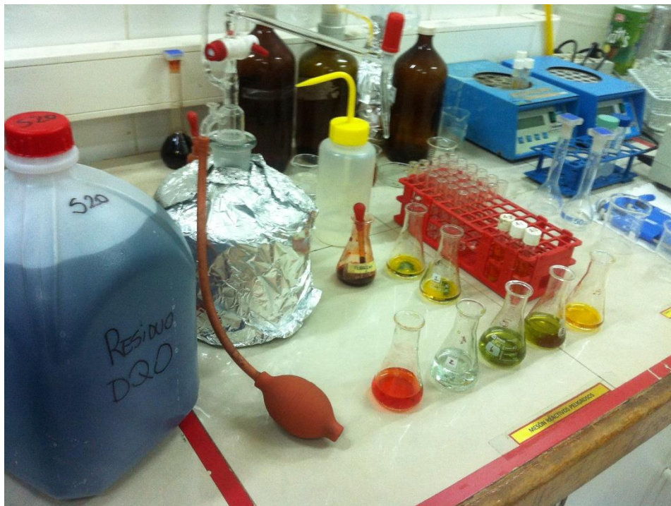
Figura 40. Estación de medición de DQO con todos los materiales y reactivos necesarios
