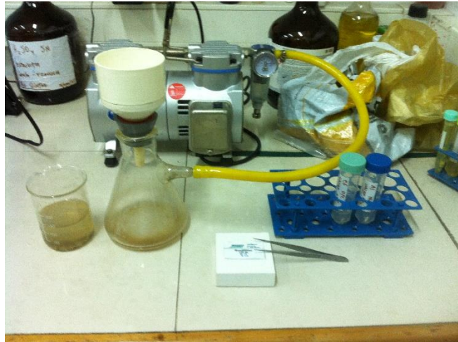
Figura 41. Estación de filtrado con materiales necesarios
