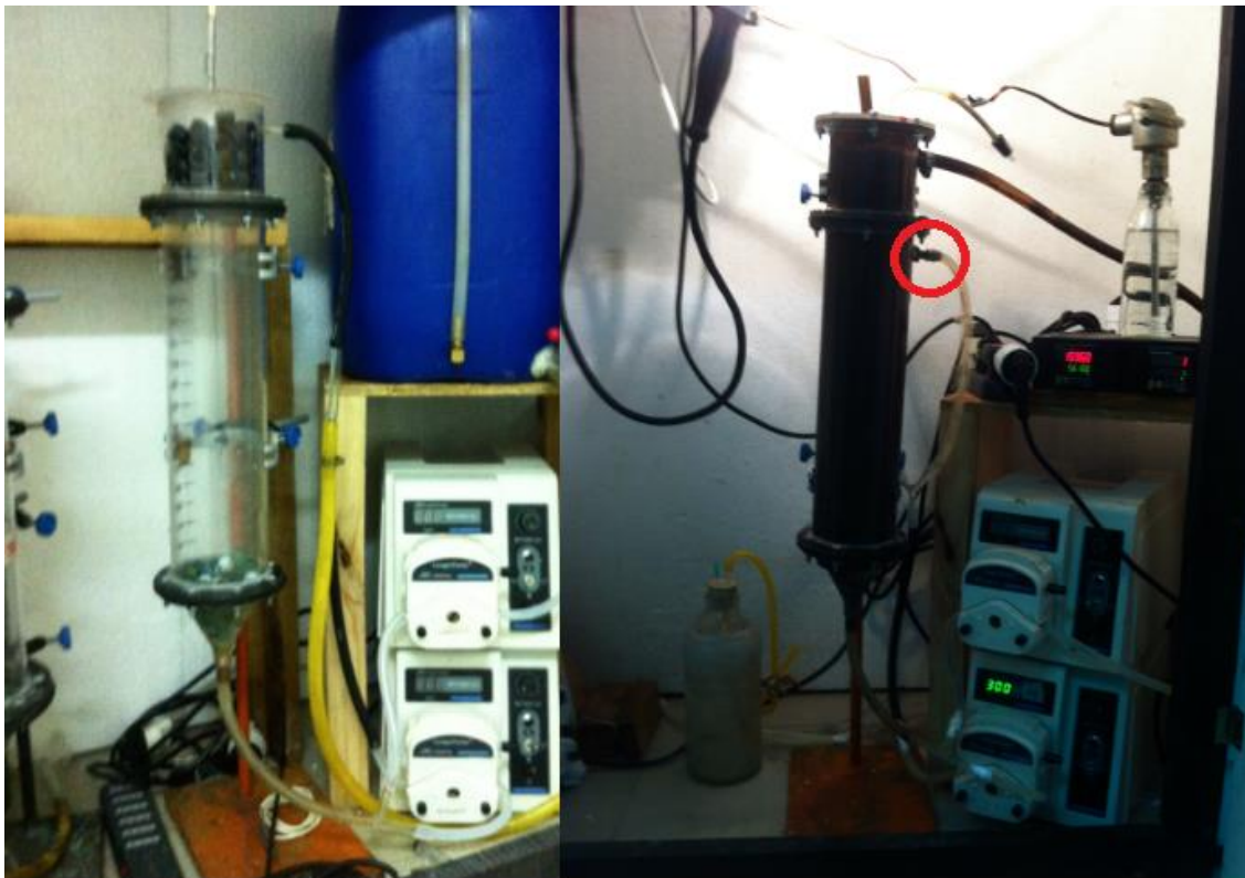
Figura 20. Fotografías del reactor a estudiar, instalado con el sistema de bombeo
