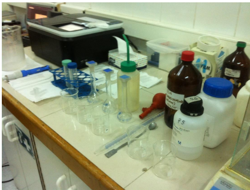
Figura 43. Estación de medición de sulfato con sus materiales y reactivos necesarios
