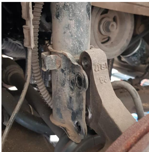
Figura N°34: Pernos del amortiguador extraídos (Fuente propia)
