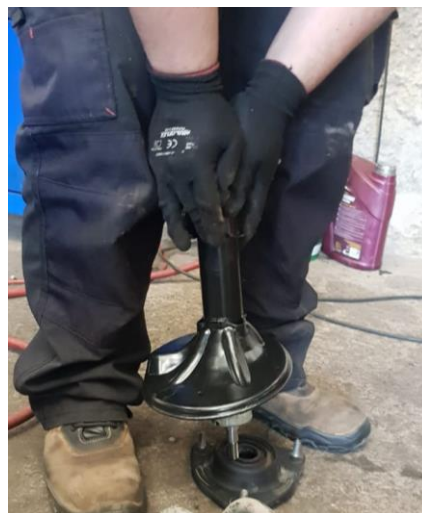
Figura N°39: Amortiguador siendo purgado (Fuente propia)
