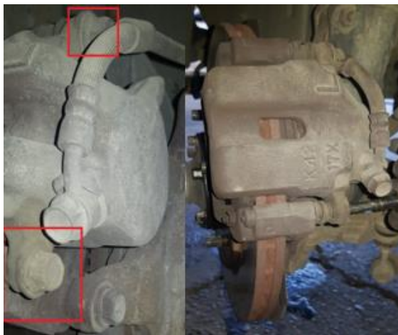
Figura N°43: Cáliper y ubicación de los pasadores (Fuente propia)
