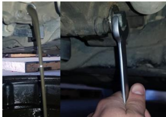
Figura N°63: Vaciado y apriete de tapón de vaciado (Fuente propia)
