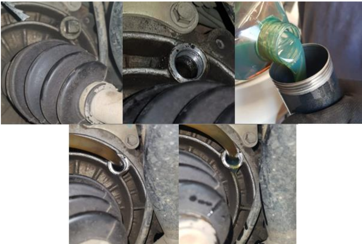
Figura N°64: Llenado de aceite de caja (Fuente propia)
