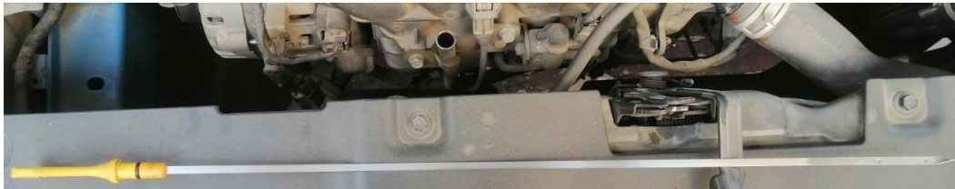
Figura N°18: Varilla de aceite (Fuente propia)
