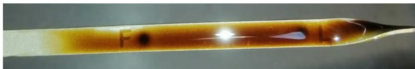
Figura N°22: Medida incorrecta del aceite (Fuente propia)
