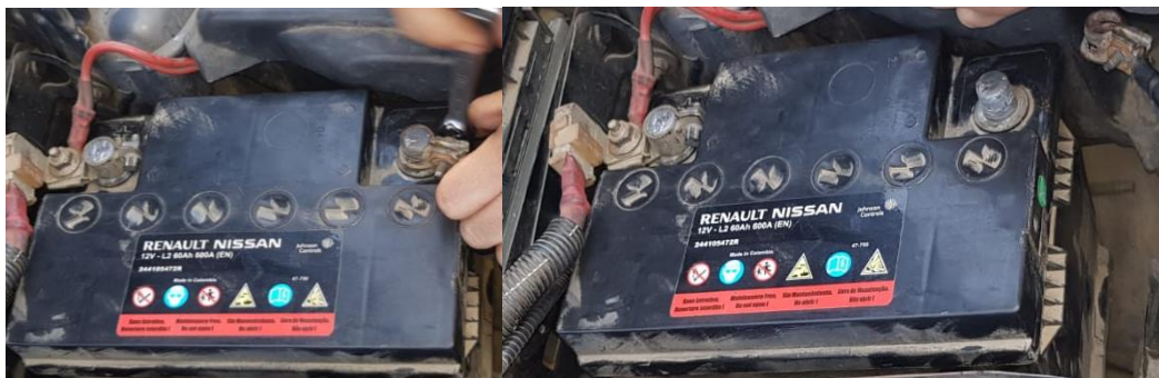
Figura N°58: Desconexión de batería usada (Fuente propia)
