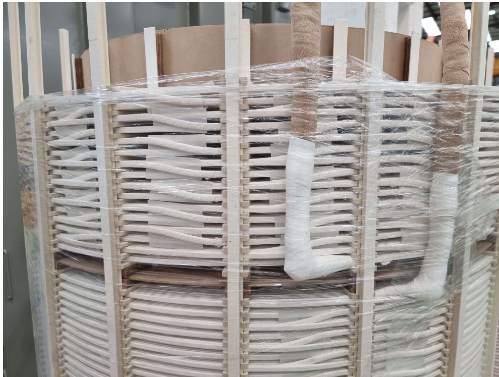
Figura 2.13: Bobina entrelazada en proceso de fabricación [32].
