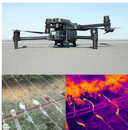
Ilustración 10: Dron con vista de cámara normal y térmica
