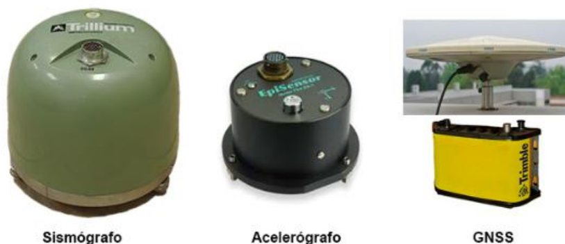
Ilustración 11: Componentes de estación sismológica
