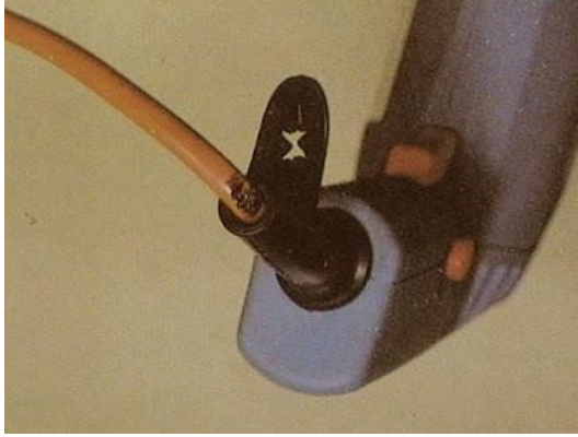
Figura 1- 14 Cable de taladro eléctrico en mal estado
