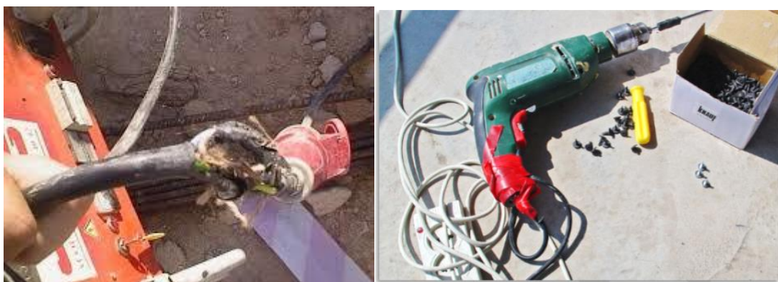
Figura 2- 16 a) Cable de alimentación cortado
