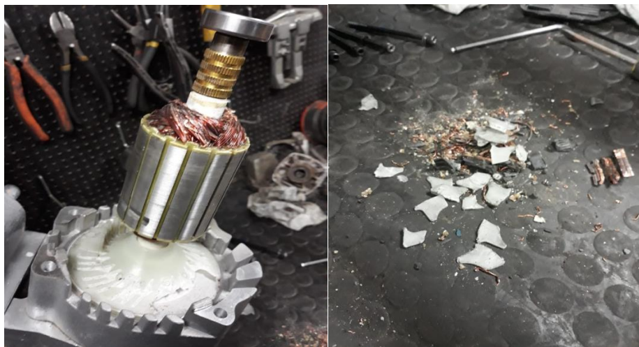
Figura 2- 25 a) Fractura de colector
