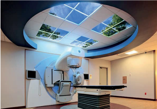
Simulación de una ventana con nubes y árboles en movimiento a través de una pantalla LCD de alta resolución, además incluye un procesador gráfico y software para la sincronización de las imágenes, para horas y horas de simulación, todo ello desde el amanecer a la puesta de sol. Fuente: Sky Factory.
