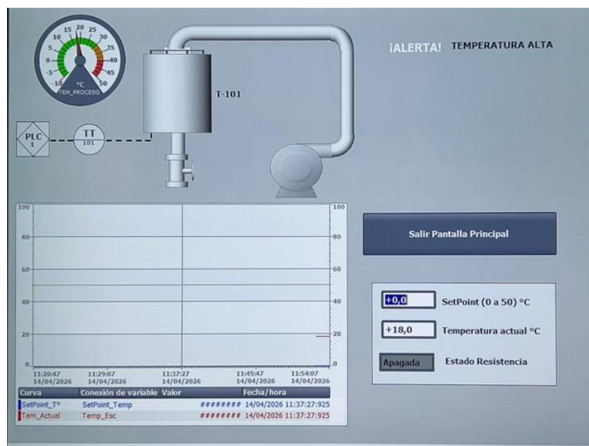
Figura 4.4: Interfaz HMI del lazo de temperatura de la planta didáctica.
