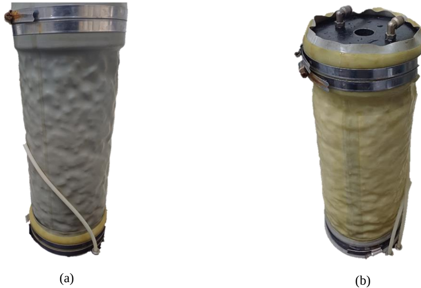
Figura 24. Probetas de ensayo triaxial representativo de 600 [kPa] (a) y representativo de 2400 [kPa] (b). Fuente: Elaboración propia.
