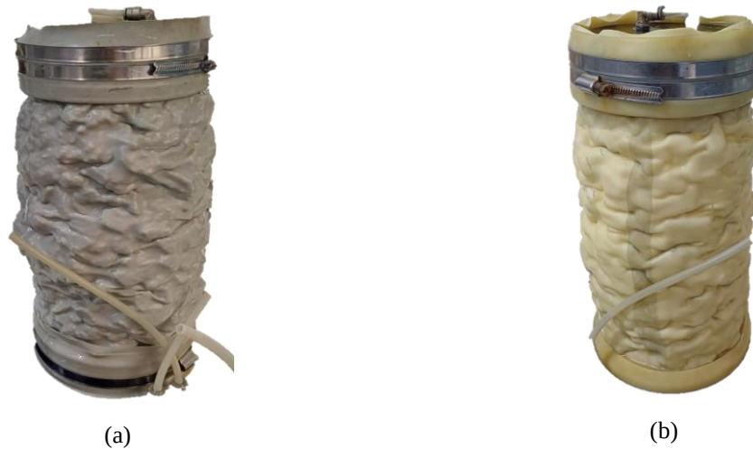
Figura 19. Probetas de ensayo triaxial a 100 [kPa] (a) y a 600 [kPa] (b) post ensayo. Fuente: Elaboración propia.
