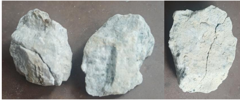
Figura 30. Partículas del material consolidado unidimensionalmente a 600 [kPa]. Fuente: Elaboración propia.
