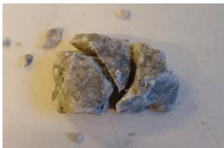
Figura 9. Partícula fracturada retirada de la probeta. Fuente: Elaboración propia.
