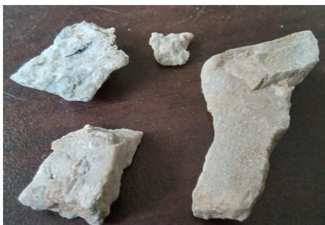
Figura 22. Partículas con rotura evidente. Fuente: Elaboración propia.
