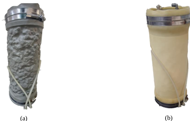
Figura 15. Probetas de ensayo triaxial a 100 [kPa] (a) y a 600 [kPa] (b). Fuente: Elaboración propia.
