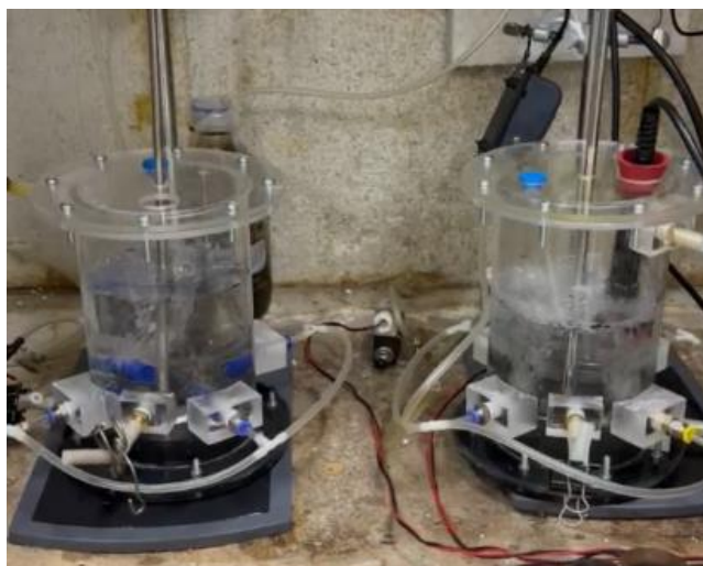
Figura 3.4. Prueba hidráulica aplicada a los reactores rediseñados con el fin de verificar la hermeticidad del sistema antes de su operación experimental.
