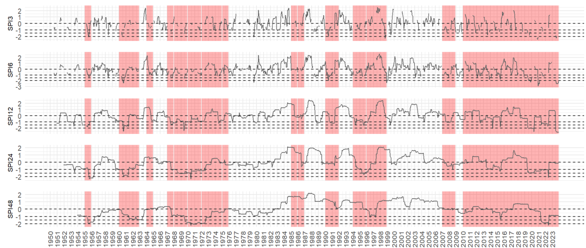
Figura 4: Serie SPI sin probabilidad condicional en cinco escalas temporales, con eventos de sequía observados en rojo. Estación La Ortiga.
