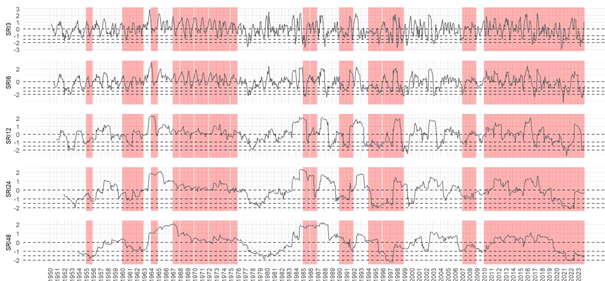
Figura 16: Serie SPEI utilizando Penman-Monteith en cinco escalas con eventos de sequía observados en rojo, estación La Ortiga.
