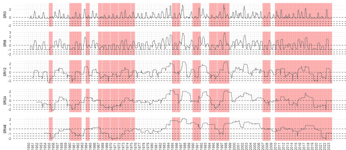
Figura 7: Serie SPI con probabilidad condicional en cinco escalas temporales, con eventos de sequía observados en rojo. Estación La Ortiga.
