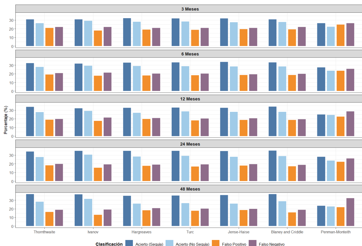
Figura 20: Comparación del desempeño del SPEI en la detección de sequías en La Ortiga con distintos métodos de evapotranspiración.
