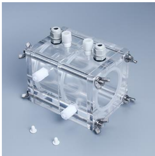
Ilustración 3: Diseño celda de combustible microbiana. Elaborado por SAIDKOCC.
