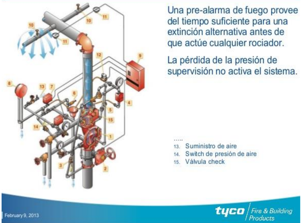
Figura 2-06 Sistema de preacción
