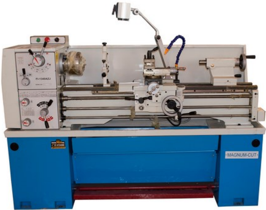
Figura 3-4: Torno mecánico paralelo 1 metro fi-1340azj
