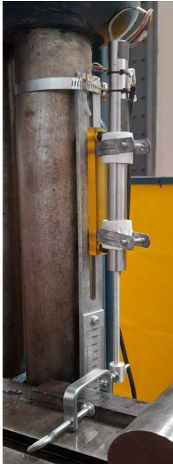
Figura 53- Instalación del transductor LVDT en la máquina Losenhausenwerk UHP-40.
