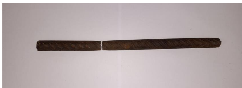
Figura 58- Barra de acero estructural ensayada bajo cargas de tracción.
