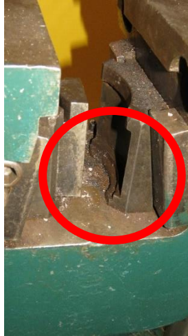
Figura 21- Fractura de porta mordazas planas de sujeción.
