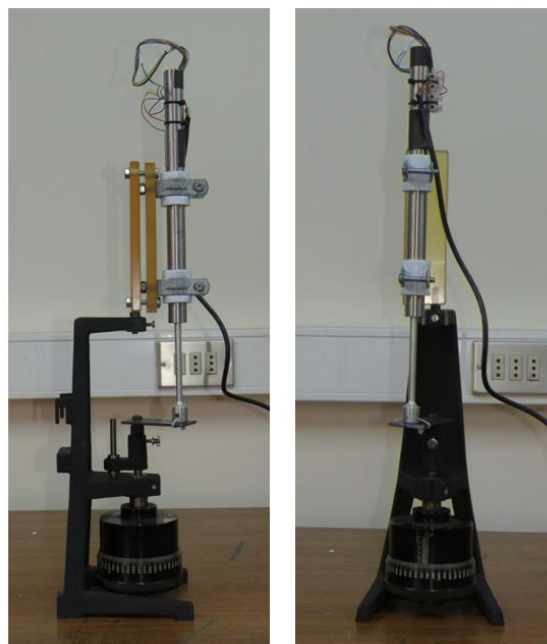
Figura 50- Arreglo de medición para calibración transductor LVDT.
