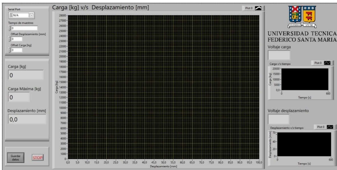
Figura 57- Interfaz de usuario diseñada en Labview para ensayos en máquina Losenhausenwerk UHP-40.
