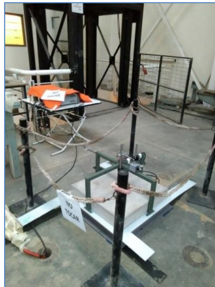
Imagen 18: Disposición de Panel con instrumentación necesaria para ensayo
