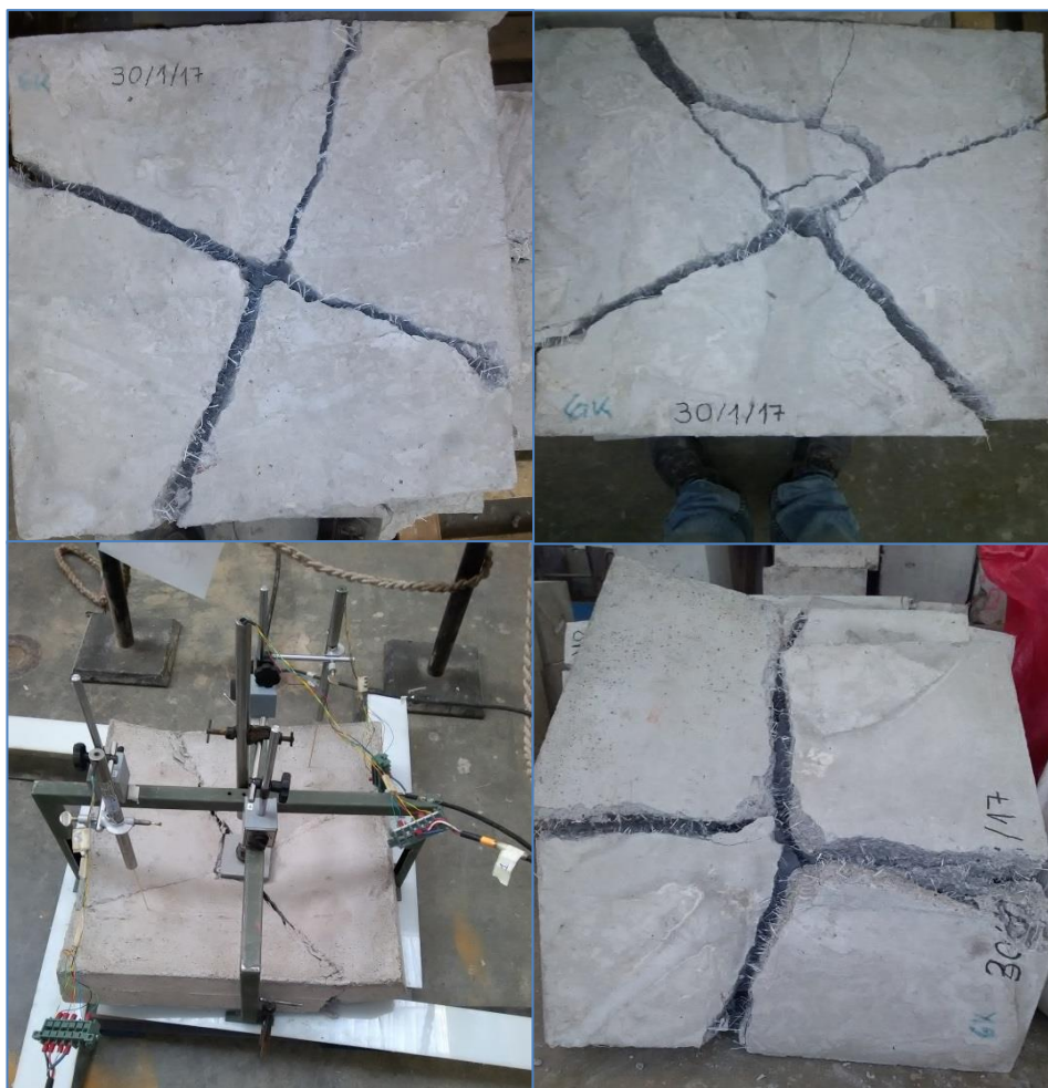
Imagen 25: Patrón de agrietamiento mostrado en paneles con cuantía de fibras sintéticas de 6 kg /m 3 , con evidencia marcada de una cruz (X) abierta
