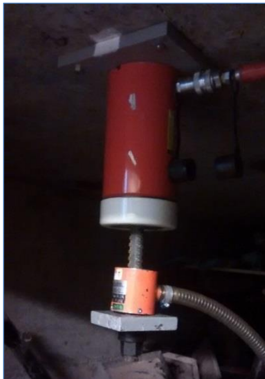
Imagen 23: Gata hidráulica, que muestra la clara tracción del perno de anclaje, una vez terminado el ensayo
