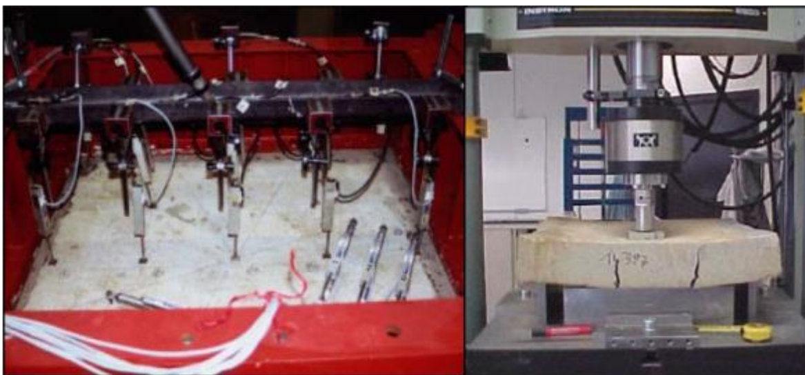
Imagen 4: Diferentes configuraciones del ensayo de panel cuadrado [Fuente: Ensayo de doble punzonamiento, aplicado al Hormigón Reforzado con Fibras, Capítulo 2: Estado del Conocimiento, 2006]
