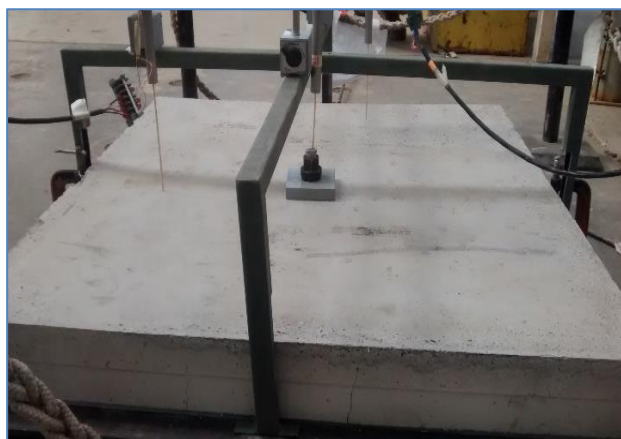
Imagen 19: Panel en posición de ensayo, junto con estructura metálica que permite apoyar LVDTs, para medir deformación en el panel
