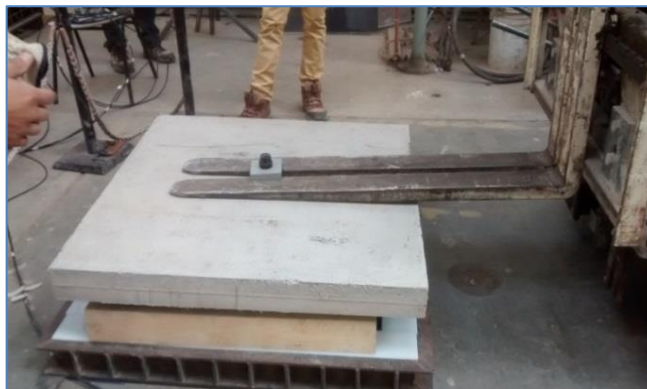
Imagen 15: Apoyo de panel de hormigón sobre cuartones de madera
