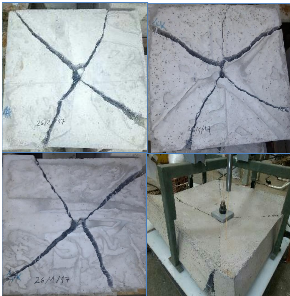
Imagen 24: Patrón de agrietamiento mostrado en paneles con cuantía de fibras sintéticas de 4 kg /m 3 , con evidencia marcada de una cruz (X) cerrada
