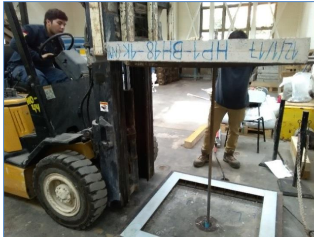
Imagen 14: Traslado de panel hacia losa de ensayo
