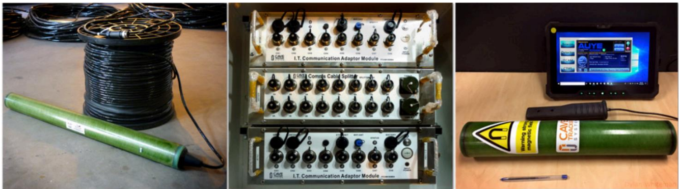
Ilustración 9.8 De izquierda a derecha se observa un detector, el ITCAM y un beacon con la interfaz inalámbrica del usuario para la activación de los dispositivos (ELEXON, 2021).
