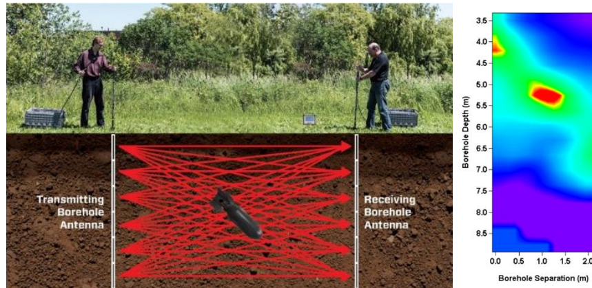
Ilustración 9.12 Metodología propuesta por especialistas de SENSING&SOFT y su un ejemplo de sus resultados donde se observa un pequeño túnel en la zona roja (SENSORS & SOFTWARE, 2021).
