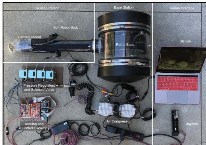
Ilustración 9.36 Componentes del Vine robot (Coad, 2019).
