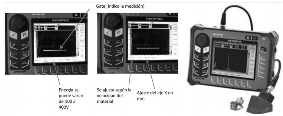
Ilustración 9.20 Dispositivo Olympus utilizado para la medición del largo de pernos con ultrasonido en la DET (Jorquiera & Celis, 2018).
