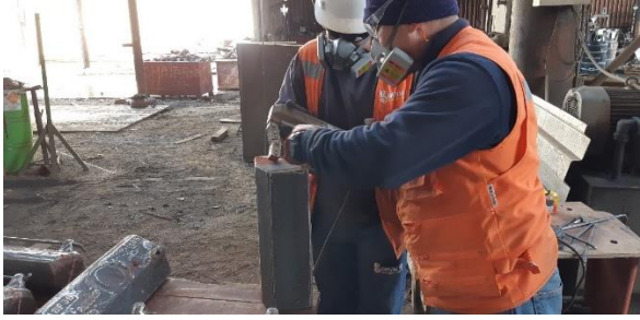
Figura 3-3 Examinación continua de partículas magnéticas(errónea).
