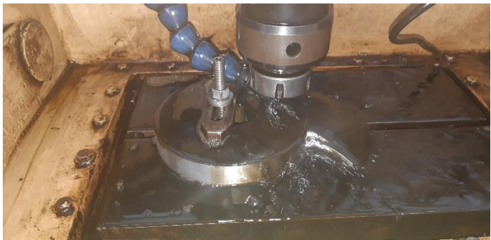
Figura 2-17 Anillo siendo Erosionado
