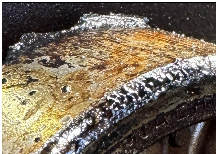
Figura 2-12. Rodamiento con barniz adherido en aro exterior. Fuente: Levantamiento fotográfico en taller de mecánica, Enap Biobío.
