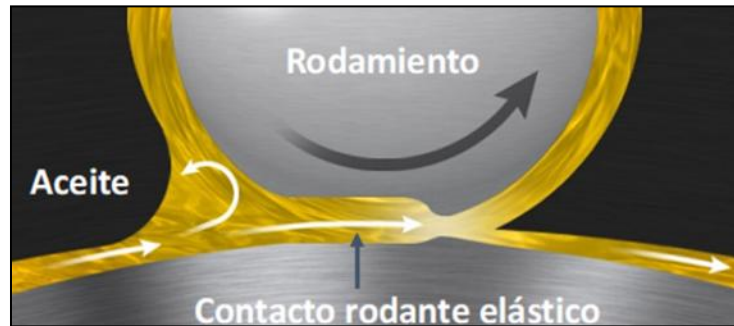
Figura 1-4. Ilustración lubricación elastohidrodinámica. Fuente: Noria latín américa.
