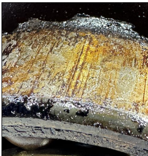
Figura 2-11. Rodamiento con barniz adherido en aro exterior. Fuente: Levantamiento fotográfico en taller de mecánica, Enap Biobío.
