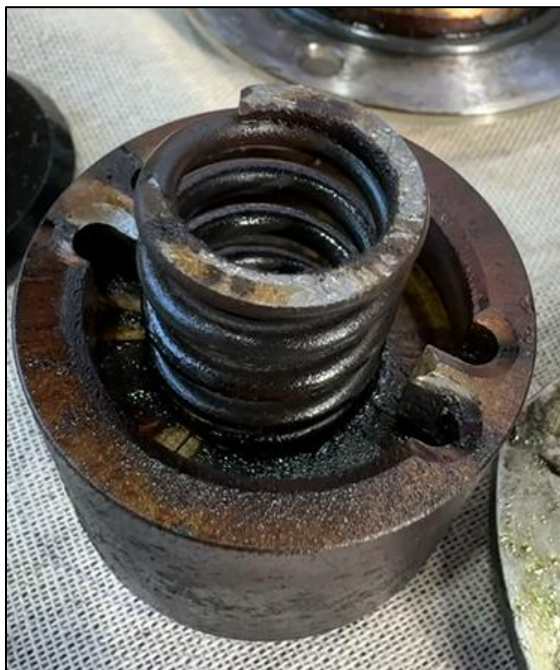
Figura 2-15. Bomba de lubricación interna de caja multiplicadora, se evidencia barniz adherido. Fuente: Levantamiento fotográfico en taller de mecánica, Enap Biobío.
