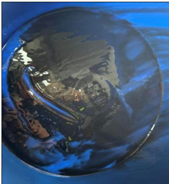
Figura 2-19. Bidón hermético de Royal Purple ISO 32 con sedimento. Fuente: Levantamiento fotográfico en terreno, Enap Biobío.
