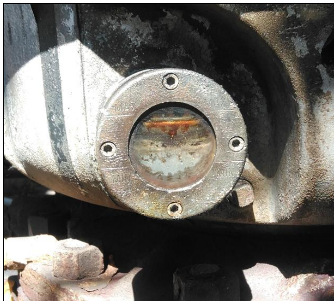
Figura 2-20. Caja multiplicadora con barniz adherido en visor. Fuente: Levantamiento fotográfico en terreno, Enap Biobío.
