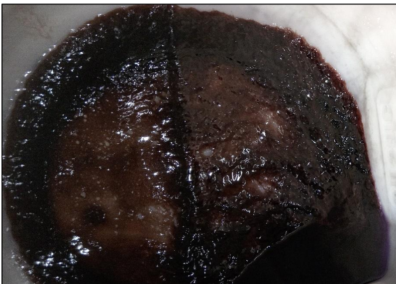
Figura 2-18. Bidón hermético de Royal Purple ISO 32 con sedimento. Fuente: Levantamiento fotográfico bodega de lubricación, Enap Biobío.
